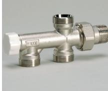
Distributore a 4 vie con attacchi a pavimento. Portata massima al corpo scaligante: 100% della portata dell'anello. Attacchi tubo rame e tubo plastica.
