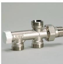
Distributore a 4 vie con attacchi a pavimento. Portata massima al corpo scaligante: 50% della portata dell'anello. Attacchi tubo rame e tubo plastica.
