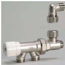
Valvola monotubo diritta a semplice regolazione orizzontale, con convogliatore di flusso. Portata massima al corpo scaldante: 50% e 100% della portata dell'anello.
