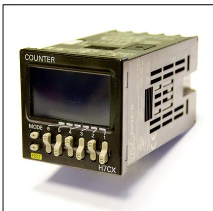
Temperatura ambiente di funzionamento:  $-10^{\circ}\text{C}$  ...  $+55^{\circ}\text{C}$  (senza formazione di ghiaccio); peso 130 g. ca.
