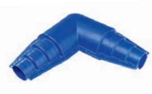
Garantisce il completo isolamento e la sigillatura ermetica dei raccordi perpendicolari tra i tubi Uno, Duo e Quadro. Il kit è composto da 2 gusci in HDPE, lana di roccia, kit di sigillatura, bulloni in acciaio inox e istruzioni di montaggio.
