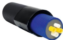
Il manicotto di attraversamento muro MMDV si compone di un tubo in HDPE profilato e di un manicotto termorestringente. Con la guaina incassata (e sporgente dal muro di circa 10 cm), il tubo Microflex viene inserito e sigillato con il manicotto termorestringente. Lo spessore del muro deve essere superiore a 40 cm.
