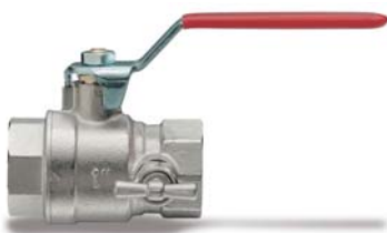
Kugelhahn PN16 mit vollem Durchgang, und Blinstopfen, IG-IG, Hebelgriff Rot
