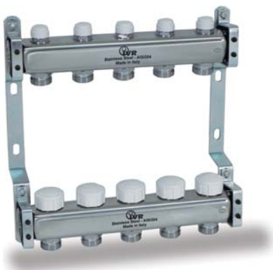
Verteiler aus rostfreiem Edelstahl AISI 304, mit thermostatisierbaren Ventilen, Einstellkappen und mikrometrischen Rücklaufverschraubungen.
