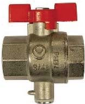
Kugelventil IG, Thermometer und Temperaturfühleranschluss, selbstdichtendem Stutzen, vernickelt
