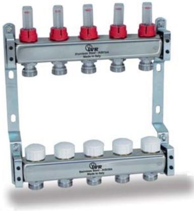
Verteiler aus rostfreiem Edelstahl AISI 304, mit thermostatisierbaren Ventilen, Einstellkappen und Durchflussmessern.
