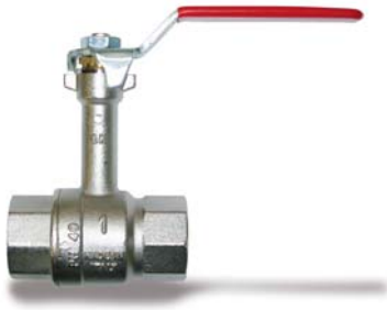
Kugelhahn PN16 mit vollem Durchgang und verlängerter Spindel, IG-IG, Hebelgriff Rot
