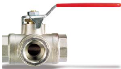
Dreiwegkugelhahn IG-IG ,PN16, Schaltweg 270°, Hebelgriff Rot, T-Bohrung
