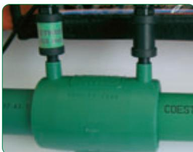
2. Attendere almeno 2 ore dal termine della saldatura prima di mettere in pressione l'impianto
