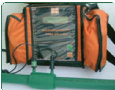
1. Introdurre il tubo raschiato e pulito nel manicotto elettrico, collegato alla saldatrice
