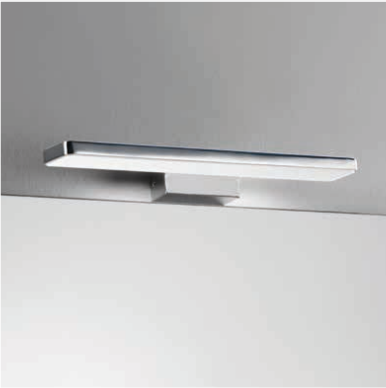
IL135P7 L.30 H.7,6 P.12,1 CE IP44 220V 4,8W LED T 200 lm - 4000K
