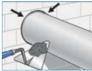
1 - Sigillare con malta le fessure intorno al tubo.
