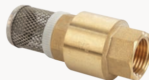
Valvola di fondo con filtro in acciaio inox F/F - PN 12 (da 1/2" a 1") F/F - PN 10 (da 1 1/4" a 2")
