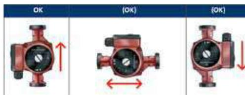
La pompa va installata sul tubo di RITORNO, nella posizione più lontana possibile.
