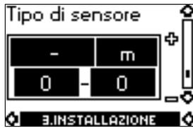
L'impostazione del tipo di sensore è da effettuarsi solo nel caso di funzionamento controllato.
