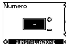
E' possibile assegnare alla pompa un numero compreso tra 1 e 64. In caso di comunicazione tramite bus, sarà necessario assegnare un numero ad ogni pompa.
