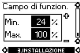
Nel caso si debba ridurre il campo di funzionamento della pompa, è possibile impostare la curva max. e min. espresse in % delle prestazioni massime, fig. 21.
