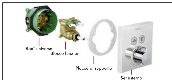
**Semplice da montare:** in caso di ristrutturazione del bagno il corpo incasso viene mantenuto. Il blocco funzioni e il set esterno si possono sostituire senza problemi.
