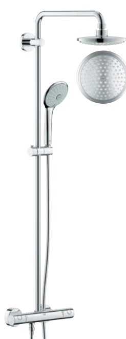
27 420 001 Euphoria System 180 sistema doccia con miscelatore termostatico soffione doccia Euphoria Cosmopolitan 180 braccio soffione sporgenza 390mm manopola doccia Euphoria 110 elemento termostatico GROHE TurboStat
