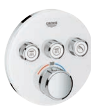
29 150 LS0 miscelatore termostatico ad 1 via elemento termostatico GROHE TurboStat blocco di sicurezza a 38° comando utenze tramite pulsante SmartControl per corpo incasso Rapido SmartBox art. 35 600 000
