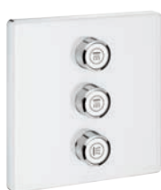
29 156 LS0 miscelatore termostatico a 2 vie elemento termostatico GROHE TurboStat blocco di sicurezza a 38° comando utenze tramite pulsante SmartControl per corpo incasso Rapido SmartBox art. 35 600 000
