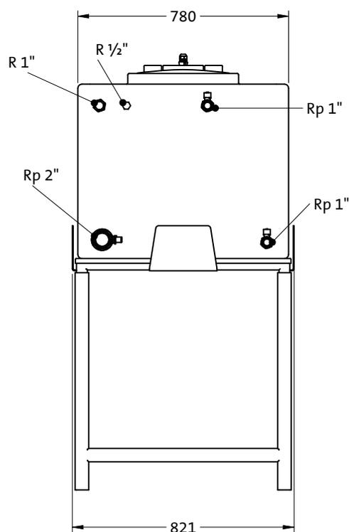
Peso del serbatoio di adescamento (vuoto): 31 kg.
