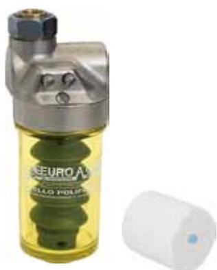
Mini dosatori proporzionali idrodinamici di Polifosfato in polvere o cilindretti preconfezionati ad uso acqua potabile. Testa in Ottone. PN 16. By-pass, regolatore di consumo, valvola spurgo frontale e codolo girevole in uscita con sistema antibatterico-Bios. È compresa una carica di Polifosfati a cartuccia.
