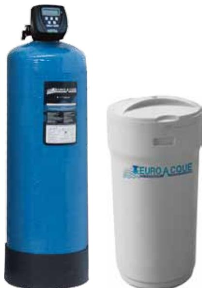
ADDOLCITORI industriali automatici **temporizzati** con timer **elettronico digitale**. Questi addolcitori sono utilizzati per medie ed alte portate. Sono dotati di corpo valvola in bronzo e di doppia sicurezza nel reintegro salamoia; chiusura temporizzata e scarico di sicurezza.
