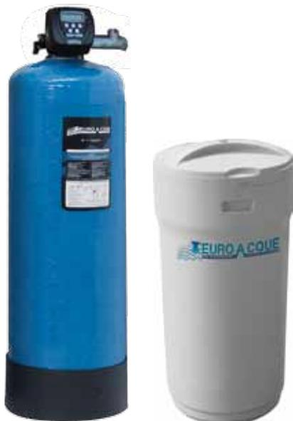
ADDOLCITORI industriali automatici **volume + tempo** con timer **elettronico digitale e contatore volumetrico**. Questi addolcitori sono utilizzati per medie ed alte portate. Sono dotati di corpo valvola in bronzo e di doppia sicurezza nel reintegro salamoia; chiusura temporizzata e scarico di sicurezza.
