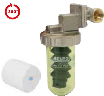
Dosatori proporzionali di Polifosfati con attacchi orientabili (rotazioni a passi 90°), testata in Ottone, ghiera fermavaso in Ottone, vite di sfiato. Gli attacchi sono dotati di n° 2 codoli girevoli con sistema antibatterico-Bios. E' compresa una carica di polifosfati a cartuccia.
