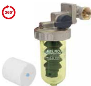
Dosatori proporzionali di polifosfato in polvere o cilindretti con attacchi orientabili (rotazioni a passi 90°), by-pass a rubinetto incorporato sulla testata in Ottone Cromato, ghiera fermavaso in Ottone, vite di sfiato frontale.
