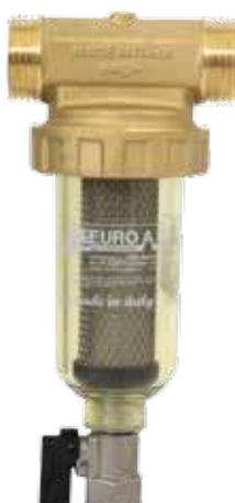
Mini Filtri pulenti - Filtro dissabbiatore pulente con testa e ghiera in Ottone. Cartuccia Inox. Pulente in quanto dotato di rubinetto di scarico che permette di espellere la sabbia senza smontare il filtro. Ovunque sia necessario avere acqua priva di solidi di piccolissime dimensioni e, in particolare, di sabbia e ove vi siano problemi di spazio consente una facile installazione. L'acqua greggia entra nel filtro e quindi, convogliata nella cartuccia, esce filtrata.
