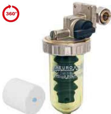
Dosatori proporzionali di Polifosfato in polvere o cilindretti con attacchi orientabili (rotazioni a passi 90°), by-pass a rubinetto incorporato sulla testata in Ottone Cromato, ghiera fermavaso in Ottone, vite di sfiato frontale.
