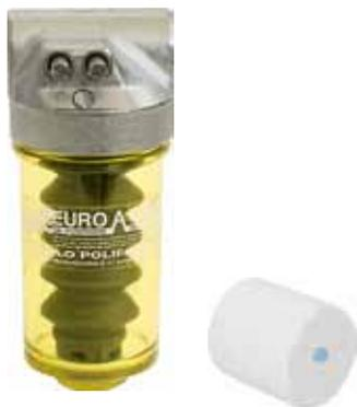
Mini dosatori proporzionali idrodinamici di Polifosfato in polvere o cilindretti preconfezionati ad uso acqua potabile. Testa in Ottone. PN 16. By-pass, regolatore di consumo e valvola spurgo frontale con sistema antibatterico-Bios. È compresa una carica di Polifosfati a cartuccia.
