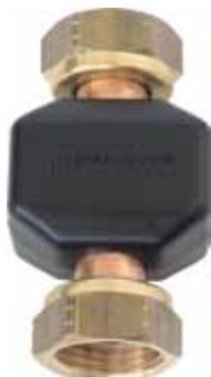
Anticalcare magnetico con codoli girevoli per una rapida e veloce installazione. Carter in materiale sintetico (per 1/2"-3/4", per versione 1" corpo in Ottone), troncetto in Rame, codoli girevoli in Ottone e nucleo magnetico in Neodimio (doppio per 1/2", quadruplo per 3/4" - 1").
