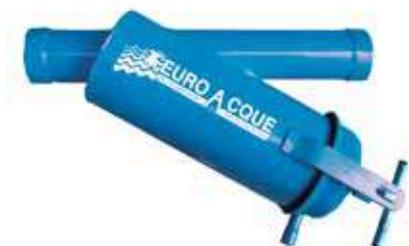
Filtri a schermo filtrante autopulenti. Lo stesso flusso di acqua in ingresso provvede alla pulizia dell'elemento filtrante che avviene grazie a un disco di accelerazione interno che crea un movimento centrifugo dell'acqua. Lo speciale rivestimento permette anche l'alloggiamento esterno.
