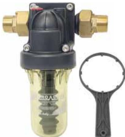
Dosatori con attacchi ruotabili 360° bocchettonati in Ottone. PN12. È compresa una carica di Polifosfati. Valvola di non ritorno incorporata e sistema antibatterico Bios. Inclusa chiave di montaggio e smontaggio vaso, vite sfiato e datario manutenzioni.
