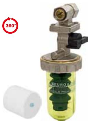
Dosatori proporzionali di Polifosfati in polvere o cilindretti con attacchi orientabili (rotazioni a passi 90°) sopraelevati a dima e muniti di codoli, by-pass a rubinetto incorporato sulla testata in Ottone Cromato, ghiera fermavaso in Ottone. Gli attacchi sono dotati di n° 2 codoli con sistema antibatterico-Bios. La sua particolare forma permette installazioni in spazi limitati come la dima delle caldaie. E' compresa una carica di Polifosfati a cartuccia.
