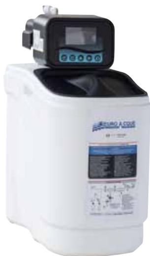
Addolcitore automatico digitale di piccole dimensioni installabile ovunque, per impianti sottolavello, macchine da caffè, lavastoviglie, piccoli appartamenti e carico impianti riscaldamento. Rigenerazione a tempo e volume. Ridotto consumo d'acqua. Dotato di **miscelatore di durezza**. L'aggiunta del produttore di cloro mod. PRODCLOR o la carica resine argentizzate, lo rende l'addolcitore "mini" ideale per uso acqua potabile.
