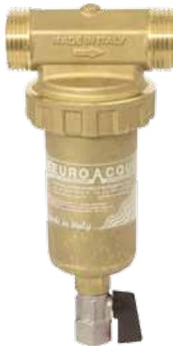
Mini Filtri pulenti - Filtro dissabbiatore pulente con testa, ghiera e vaso in Ottone. Cartuccia Inox. Pulente in quanto dotato di rubinetto di scarico che permette di espellere la sabbia senza smontaggio.
