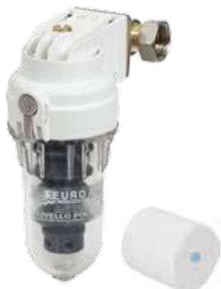
Dosatore proporzionale di polifosfato in polvere o cilindretti con attacchi orientabili (rotazioni a passi 90°) con esclusivo sistema interno brevettato che consente il by-pass automatico + sfiato unicamente premendo il pulsante "click" e ruotando il vaso del dosatore. E' l'unico dosatore che consente una sostituzione sicura, rapida, facile e veloce della carica di polifosfato; basta un "click"!
