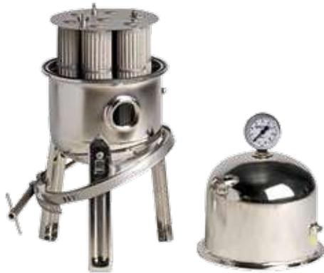
Filtri a batteria costruiti interamente in Acciaio Inox. All'interno possono alloggiare più cartucce in acciaio Inox, Nylon e Filo avvolto. Varie filtrazioni a richiesta. I filtri FB sono costruiti di serie in acciaio inox AISI 304. I filtri FB sono costituiti da due gusci, con fondi bombati stampati, in lamiera d'Acciaio Inossidabile e uniti per mezzo di due flange saldate, con una guarnizione toroidale in elastomero interposta.
