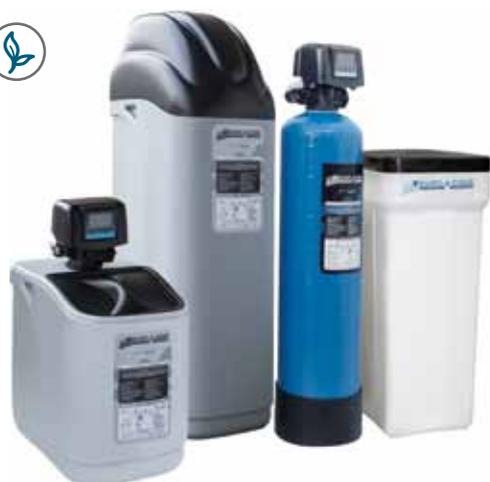
Addolcitori automatici serie AF DIGIT/V (timer con display retro illuminato) a lettura digitale **autodisinfettanti** con rigenerazione a **volume + tempo**. Ad uso potabile. Il nuovo sistema di controllo elettronico delle fasi e la rigenerazione proporzionale permette una riduzione nei consumi di sale. Sono dotati di **miscelatore di durezza** integrato nel corpo valvola.
