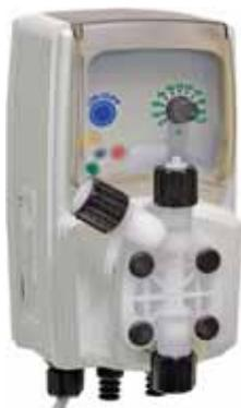
Pompa dosatrice a controllo manuale per **dosaggio costante (on/off)**, con sonda di livello (evita la marcia a secco) per pescaggio diretto da tanica + segnalazione (led rosso) di fine prodotto, valvola di iniezione, fondo/filtro, tubo aspirazione/ mandata/ scarico aria.
