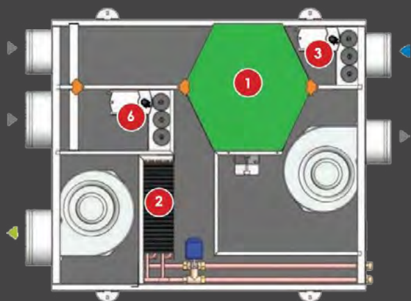
Con serrande di aspirazione e di bypass (Il dispositivo di recupero del calore viene bypassato sul lato di aspirazione dell'aria)
