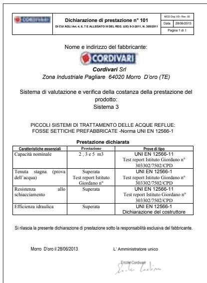
DICHIARAZIONE DI PRESTAZIONE (DOP) PER VASCHE SETTICHE SECONDO LA NORMA EN 12566-1
