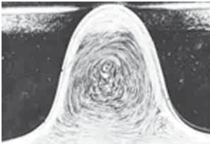
Nello scambiatore corrugato si formano delle turbolenze che movimentano e scambiano di continuo l'acqua. Al flusso di corrente base si sovrappone una componente di torsione creata dalla forma costruttiva stessa, producendo in tal modo ulteriori vortici. Pertanto si ottiene il massimo scambio di calore, evitando il deposito di calcare.
