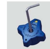
C) Rimuovere il cappuccio verde dal volantino. Usando una brugola da 4mm ruotare il dispositivo di memoria in senso orario fino al suo arresto: la massima apertura della valvola è così settata a 2.5 giri.
