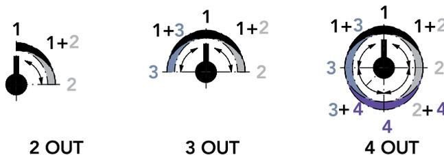
**SCHEME OPERATION SWITCHES FLUSH OUTPUT 2/3/4**
