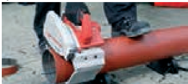
Taglio di tubi in acciaio fino a Ø 250 mm (PIPECUT TURBO 250)
