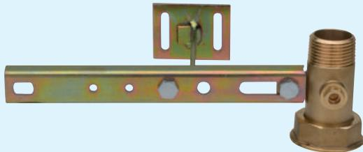
Traversa in acciaio interasse 250 mm, con cannotto in ottone e presa pressione filettatura ISO 7/1, zanca h.115 per tasselli ad espansione.
