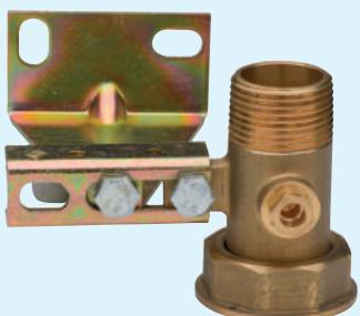
**IT** Traversa in acciaio, interasse 110 mm con cannotto in ottone e presa pressione, filettatura ISO 7/1, zanca triangolare per tasselli ad espansione.
