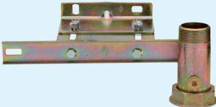
**Italiano:** Traversa in acciaio con canotto filettato UNI EN 10226/1 e presa pressione UNI ISO 228/1 G 1/4", zanca a muro regolabile per contatori G10-G16.
