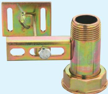
Traversa in acciaio, interasse 110 mm con canotto, filettatura UNI ISO 228 e zanca h.85 per tasselli ad espansione.
