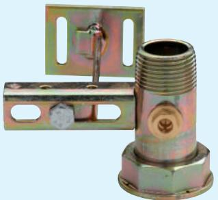
Traversa in acciaio, interasse 110 mm con canotto presa pressione, filettatura ISO 7/1 e zanca h.115 per tasselli ad espansione.
