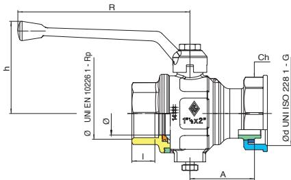
**Italiano:** Valvola a sfera a passaggio totale per contatore gas, con attacco per ferro mensola. Ingresso femmina e leva in alluminio.
