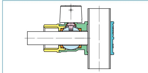
Iniziare l'installazione avendo cura di pulire e rendere liscia da asperità o rigature la parte di tubo in ferro dove verrà installata la valvola, in particolare nella zona circostante a ove verrà effettuato il foro, in corrispondenza della zona di contatto con la guarnizione.
