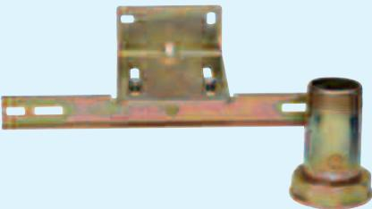
**Italiano:** Traversa in acciaio, con canotto filettato UNI EN 10226/1 e presa pressione UNI ISO 228/1 G 1/4", zanca a muro regolabile per contatori G10-G16-G25.
