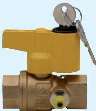
**Valvola a sfera per gas a passaggio totale diritta, post-contatore con punto presa pressione di sicurezza, attacchi F/F e serratura di sicurezza.**
