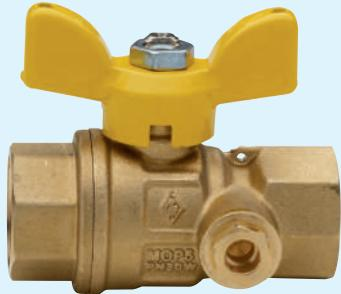
Valvola a sfera per gas a passaggio totale diritta, post-contatore con punto presa pressione laterale, attacchi F/F e farfalla in alluminio.
