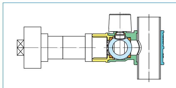
Inserire l'attrezzo foratubi avvitandolo sulla valvola, ponendo attenzione che la sfera sia aperta. Facendo ruotare la chiave e la ghiera dell'attrezzatura, procedere con la foratura della tubazione in ferro.
