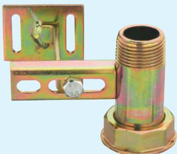
**Italiano:** Traversa in acciaio, interasse 110 mm con canotto, filettatura ISO 7/1 e zanca h.85 per tasselli ad espansione.
