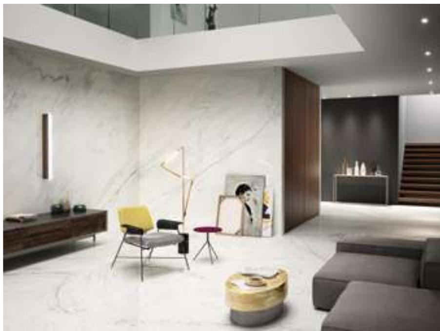
Disponibile en dos acabados y cinco formatos. Semisatinado: representa un compromiso entre el acabado pulido y natural. Brillante: se obtiene mediante un tratamiento post-producción que es efectuado por cabezas de diamante bruto que aumentan la brillantez y la dureza final. Acabado ideal para la pavimentación de interiores.
