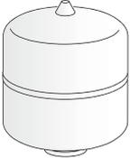
Vaso d'espansione sanitario, grigio, da 8 litri, integrabile (accessorio). Pressione di pre-carica 4 bar. Solo per installazione interna alla caldaia Condens 9000i WM di un solo vaso, con CS10 e CS11. Integrazione interna non possibile se in presenza di CS12 o CS13. Staffa predisposta anche per fissaggio a parete | 7 738 112 125 | <b>114,00</b>      |
