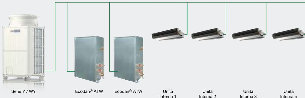
Con unità esterne della serie Y, la funzione è applicabile solo su impianti misti e si traduce nella possibilità di connettere indici di capacità di unità interne (riscaldamento o raffreddamento ad aria) e di moduli idronici Ecodan® ATW (riscaldamento o raffreddamento ad acqua) fino al 200% dell'indice di capacità dell'unità esterna.\*
