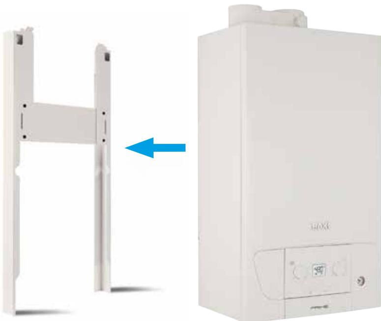
Il telaio distanziale permette di allontanare la caldaia dal muro di 40 mm consentendo il passaggio delle tubazioni nella parte posteriore dello schienale. Questo accessorio facilita la sostituzione della caldaia eliminando i lavori di muratura.
